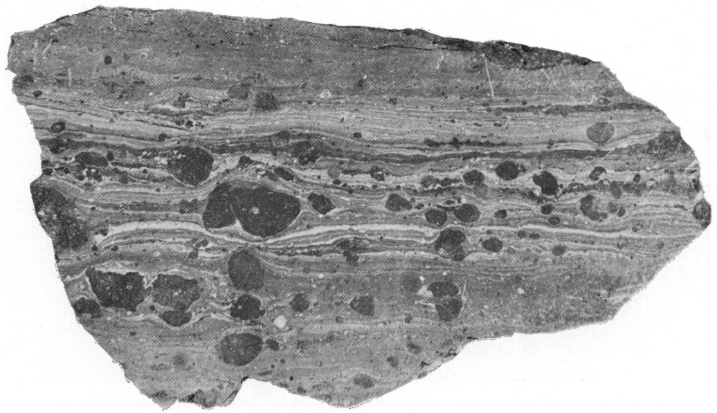
Photo 1. — Bauxite régulièrement stratifiée à laminae alternés rouges et blanches; galets de bauxite rouge. Gisement d'Uston. X 0,9
